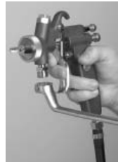
4. Doppelnippel 1/4 - 3/8" einschrauben und festziehen (SW 17).
