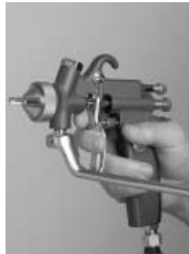
2. Stopfen mit einem Schlüssel (SW 17) lösen, herausdrehen und ...
