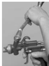
3. Visser dans le raccord du godet gravité, serrer.
