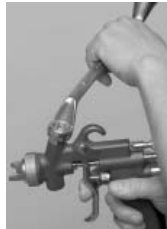
3. im Fließbecheranschluss einschrauben und festziehen.
