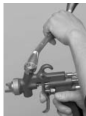
3. Proppen skrues herefter ind i tilløbsbæger-tilslutningen og spændes.
