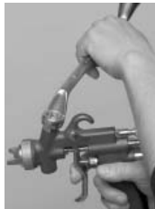
3. Op de bovenbekeraan sluiting schroeven en vastdraaien.
