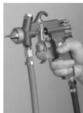
5. Fixer le flexible d'alimentation produit.
