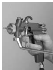
2. Dévisser le bouchon (clé de 17) le retirer et...
