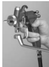
4. Dubbele nippel 1/4" - 3/8" erop schroeven en vastdraaien (SW 17).
