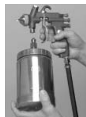
5. Fixer le flexible d'alimentation produit.
