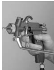
2. Afdopplug met een sleutel (SW 17) losdraaien, eruit schroeven en ...
