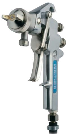
Die PILOT XIII ist sowohl bei brennbaren als auch nicht-brennbaren Lösemittelklebern einsetzbar. Darüber hinaus ist sie zur Verarbeitung von Polyurethanklebern bestens geeignet. Die materialführenden Teile sind aus Edelstahl.
