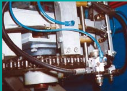
Ovalläufer mit 24 Airless-Automatik- Spritzpistolen für die Latexbeschich- tung der Innenwattierung von Ski-Anoraks
