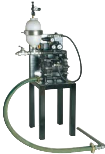
Doppelmembranpumpe MBP 8034 montiert auf „Stuhl“ für Dispersionsklebstoffe. Die Einheit ist weiterhin mit einem Pulsationsdämpfer, einer Druckluft-Armatur sowie einem Ansaugschlauch bestückt. Bis zu 3 automatische Spritzpistolen können mit Material versorgt werden.
