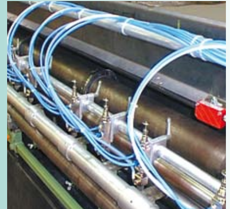
Markieren von Nähten für die Anfertigung von Autositzen
