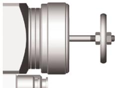
1. Ziehen Sie die Zugstange der Spritzpistole nach hinten. Die Materialzufuhr wird geöffnet und Materialkanal und -düse werden gereinigt.
