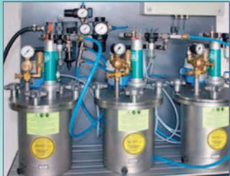
Farbversorgung mit Kleindruckbehältern, ausgerüstet mit Druckluftrührwerken
