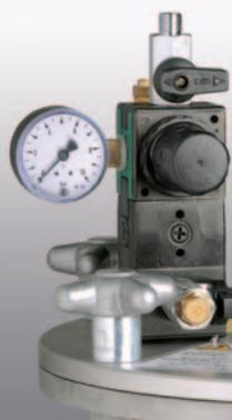
Drucklufteinlassarmatur mit zweitem Regler für den Anschluss einer Spritzpistole
