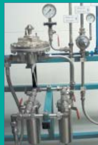
Detailansicht: Pulsationsdämpfer, Doppelfilter- armatur, Rücklaufregler
