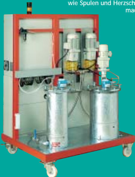
Maschine zum Mischen und Dosieren von zwei-komponentigen Vergussmassen, z.B. Epoxidharze, Polyurethane, Silikone
