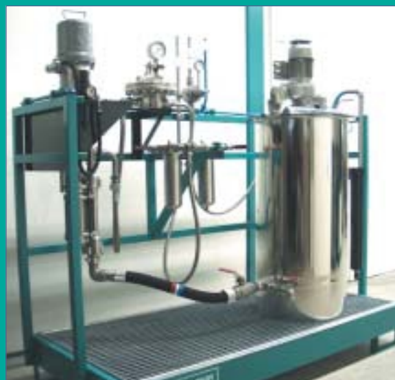
Detailansicht: Pulsationsdämpfer, Doppelfilter- armatur, Rücklaufregler
