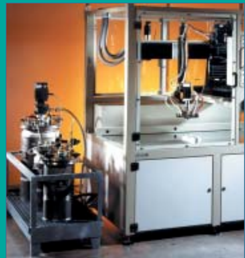
Maschine zum Mischen und Dosieren von zwei-komponentigen Vergussmassen, z.B. Epoxidharze, Polyurethane, Silikone
