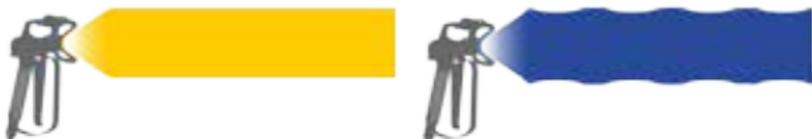
A faible pression : jet de pulvérisation régulier avec une pompe à membrane (schéma jaune) et jet irrégulier avec une pompe à piston (schéma bleu).
