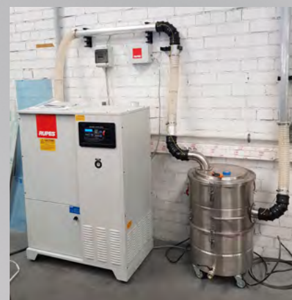
Turbine centrale avec filtre à émulsion
