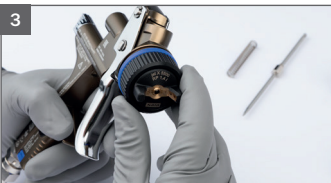
Assemblage van de luchtkap
