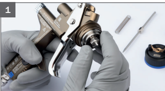
Montage van de spuittip
