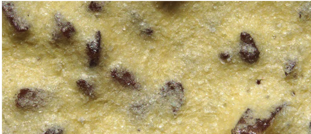
Microscopische weergave van het korrelpatroon van de MULTIPURPOSE Schuurschijven op papier.
