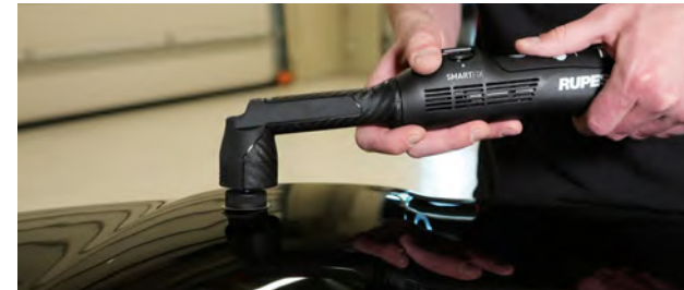
Gelakte oppervlakken. Verwijdering van lakfouten zoals stofpuntjes en zakkers.
