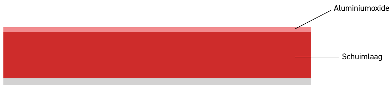
2D-tekening van de korrelstructuur van de WET&DRYFINISH Schuimpads.
