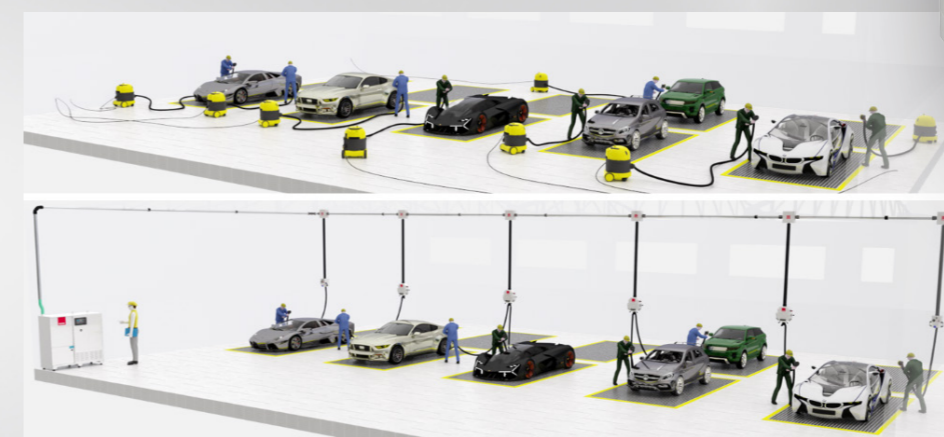
Exemple : comparaison de situation avec 8 outils actifs équipés d'aspiration – en haut, aspirateurs mobiles ; en bas, installation de turbine avec unités de contrôle.
