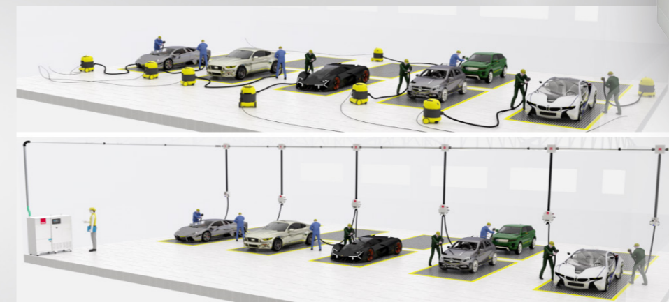
Voorbeeld: situatievergelijking met 8 actieve tools met stofafzuiging - boven mobiele stofafzuigers, onder turbine installatie met control units.
