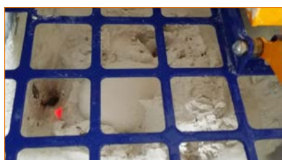
Regeling van het reservoirniveau via lasermeting voor minimaal productverlies
