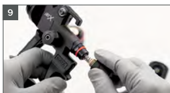
Installeer de schroef voor de materiaalstroom.
