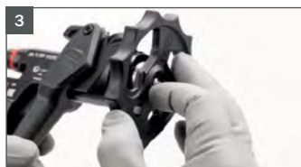
Schroef ten slotte de nozzle los met de ringsleutel die in de universele sleutel is geïntegreerd.
