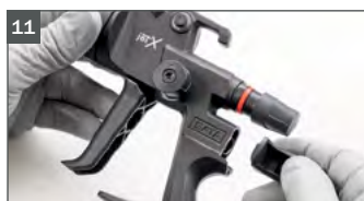
De QAC-afdekking plaatsen.
