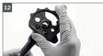
Lijn de nozzle uit met de universele sleutel (optioneel).
