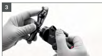
Als alternatief kan het geïntegreerde gereedschap van de trekkerbeugel worden gebruikt.
