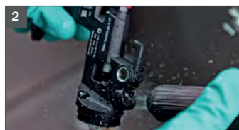
Reinig het pistoollichaam.
