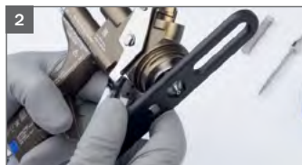
2 Draai de spuittip manueel vast met de universele sleutel.
