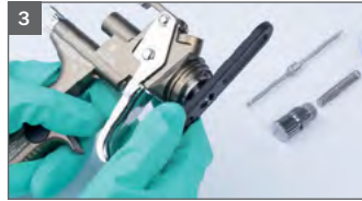
3 En tot slot, draai de spuittip los met de ringsleutel welke geïntegreerd is in de universele sleutel.
