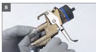
8 Installeer de schroef voor de materiaalstroom
