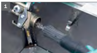
Reinig de materiaaldoorgang
