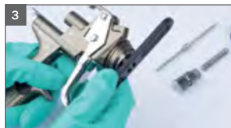
En tot slot, draai de spuittip los met de ringsleutel welke geïntegreerd is in de universele sleutel.
