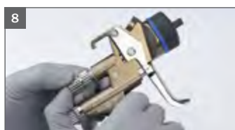
Installeer de schroef voor de materiaalstroom
