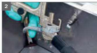
Reinig het pistoollichaam
